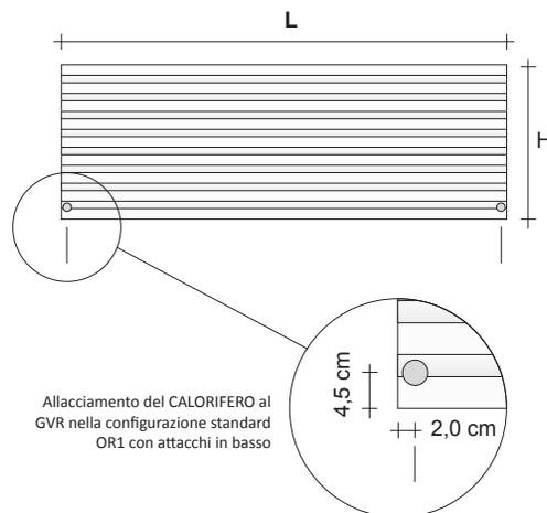
Allacciamento del CALORIFERO al GVR nella configurazione standard OR1 con attacchi in basso
