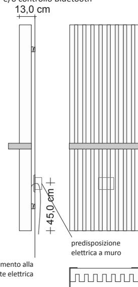
Modalità di allacciamento al termostato wireless Tubes ECOdesign
