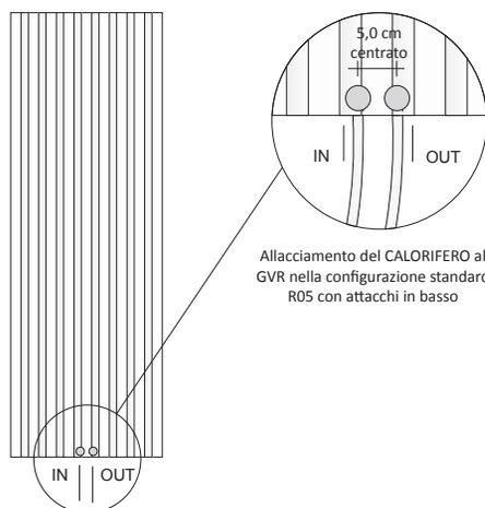
Allacciamento del CALORIFERO al GVR nella configurazione standard R05 con attacchi in basso
